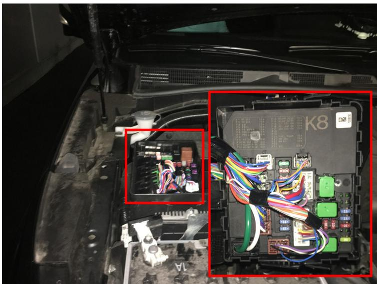
Рис.5 Место подключения реле в блоке IPDM
