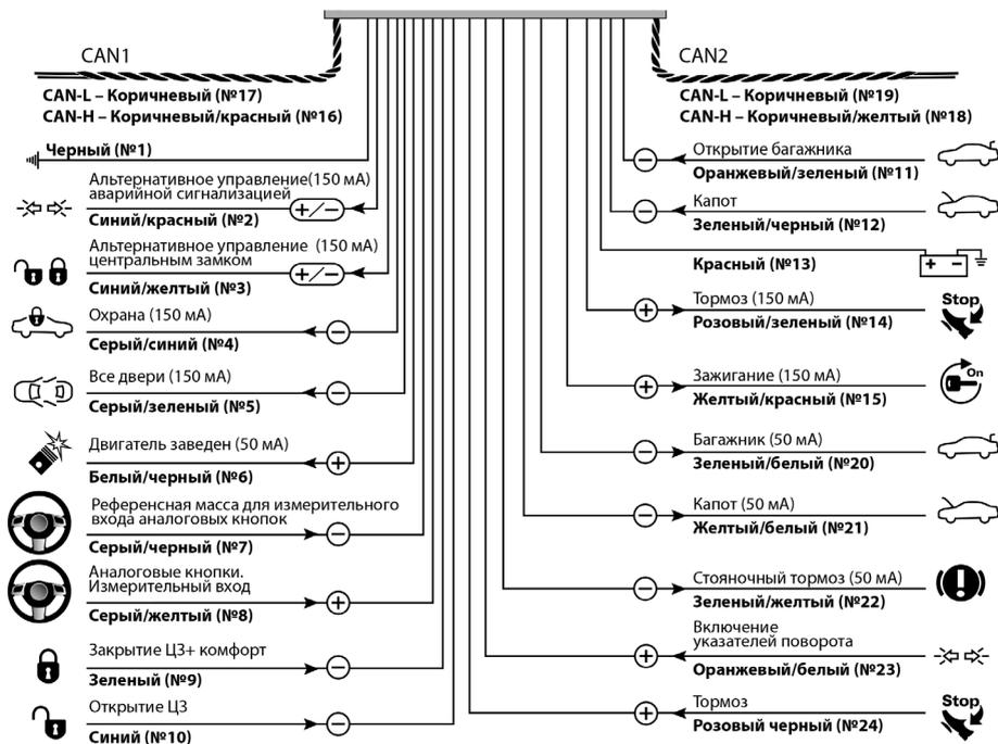
Рис. 1б. Назначение выводов модуля
